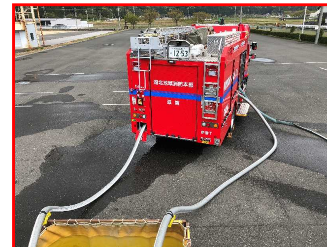
河川や防火水槽からの吸水
