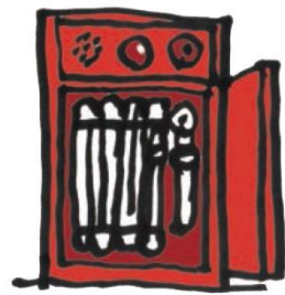
屋内消火栓設備
