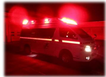
車両側面及び後方には高い反射性能を有する反射テープを使用しています。
